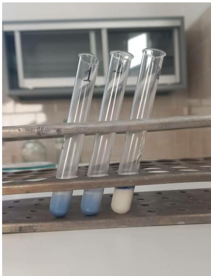
Рис.1. Кольцевая реакция молока (1- проба отрицательный, 2-проба сомнительный результат, 3 проба-положительная).
